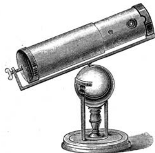
Первый зеркальный телескоп И. Ньютона и его схема.
