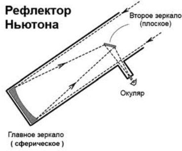
Первый зеркальный телескоп И. Ньютона и его схема.
